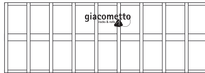
Bohrschlammmulde 20 m 3 L: 6,20m / B: 2,30m / H: 1,75 m
